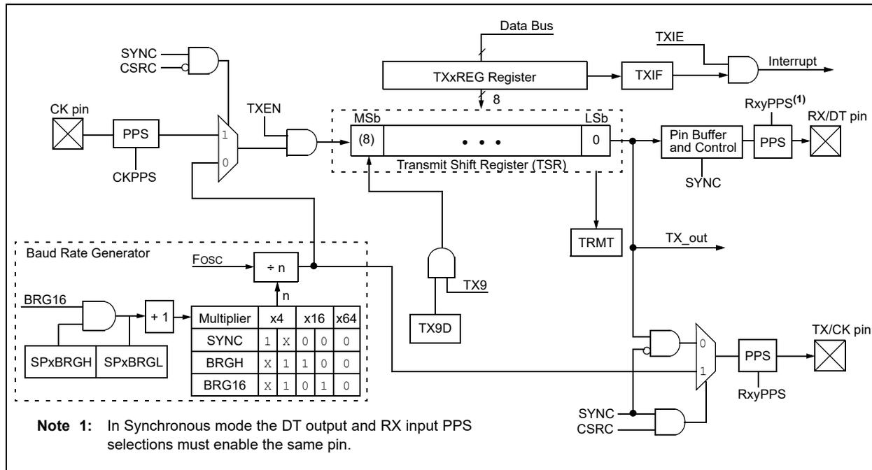
**FIGURE 25-2: EUSART RECEIVE BLOCK DIAGRAM**
