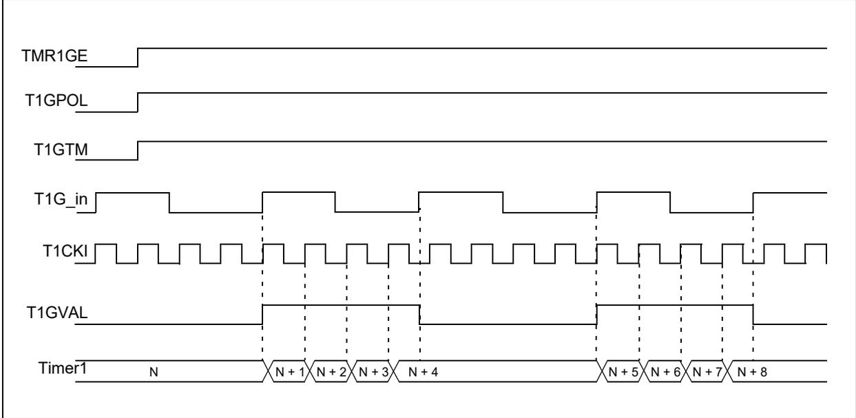
FIGURE 22-5: TIMER1 GATE SINGLE-PULSE MODE
