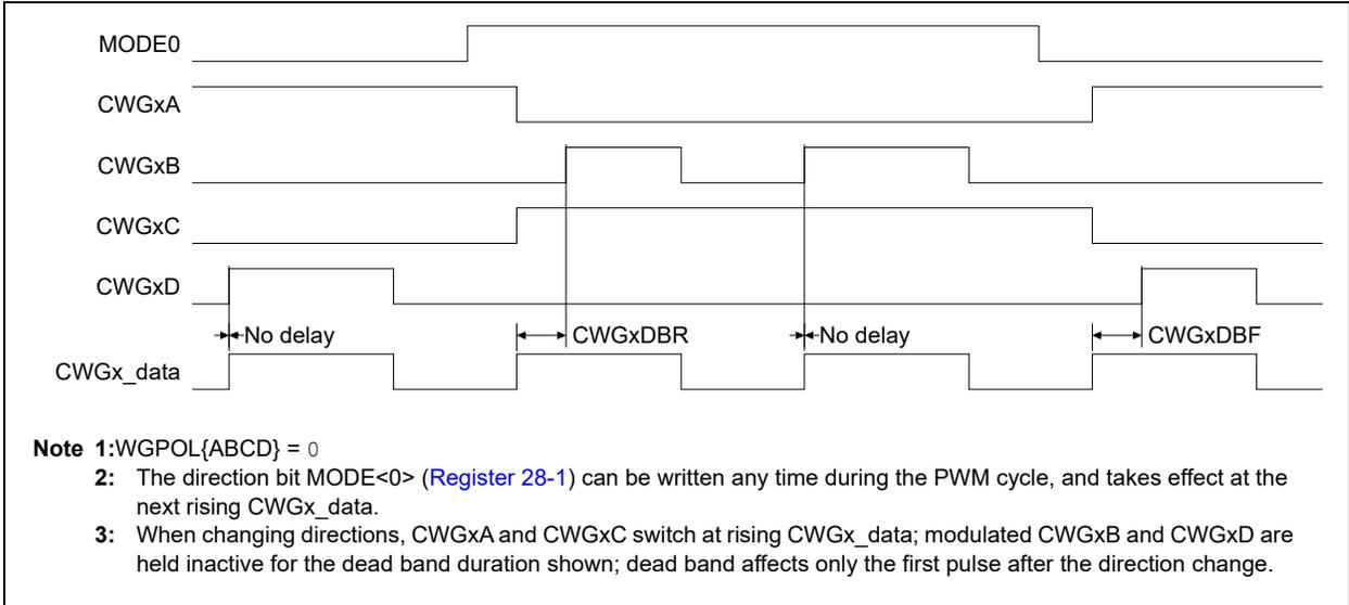
**FIGURE 28-9: CWG HALF-BRIDGE MODE OPERATION**
