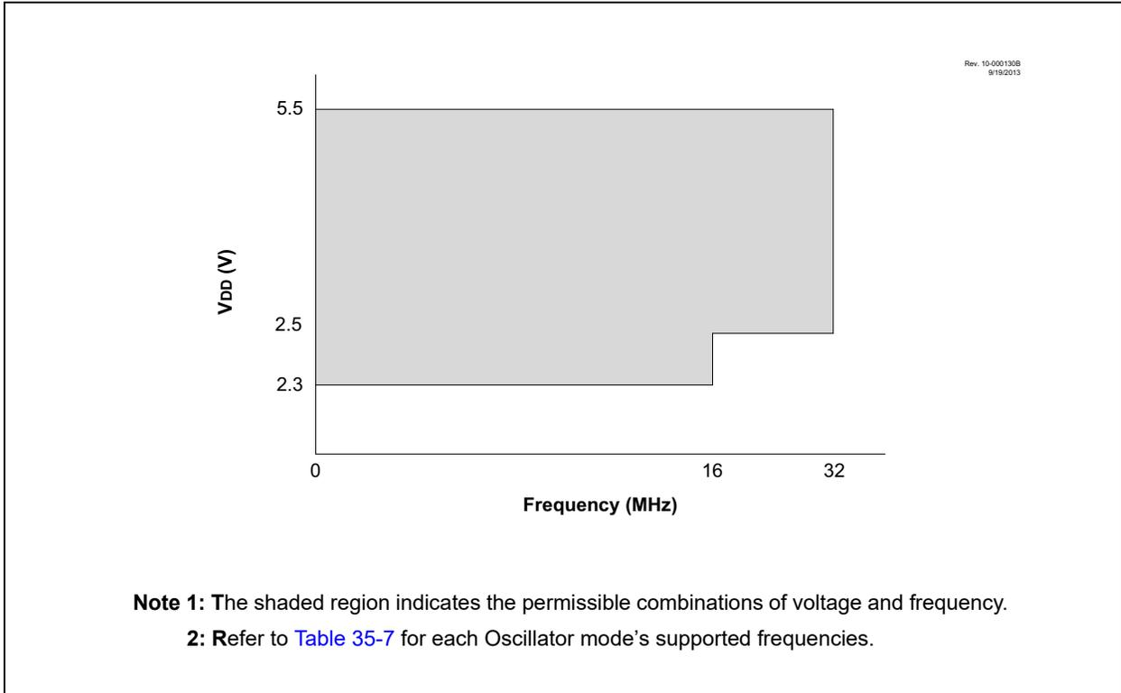
**FIGURE 35-2: VOLTAGE FREQUENCY GRAPH,  $-40^{\circ}\text{C} \leq T_A \leq +125^{\circ}\text{C}$ , PIC16LF1615/9 ONLY**
