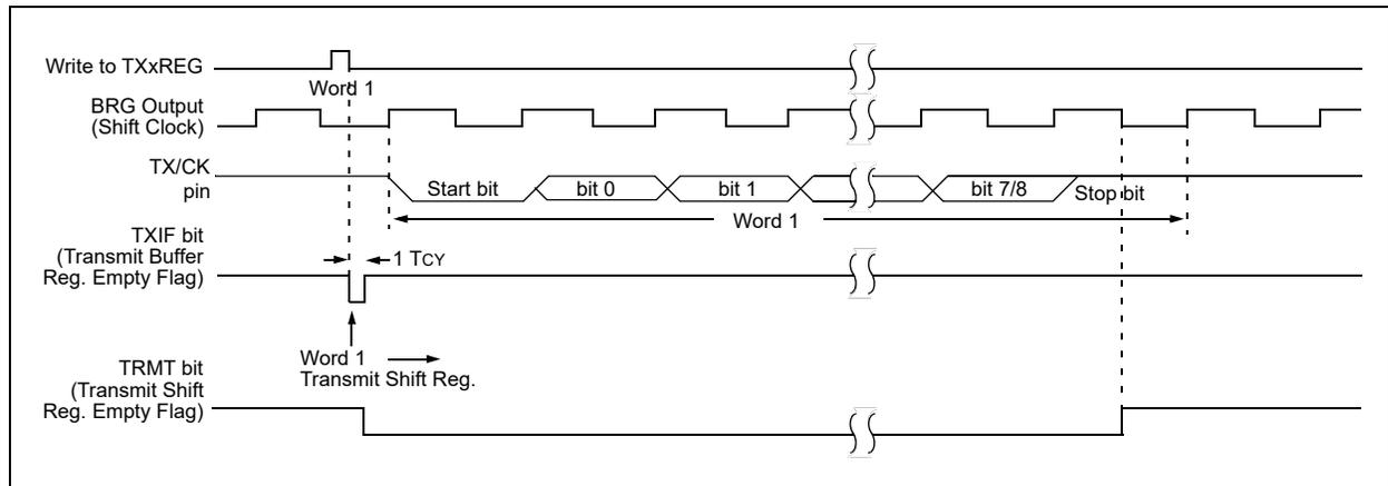
**FIGURE 25-4: ASYNCHRONOUS TRANSMISSION (BACK-TO-BACK)**
