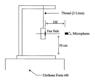
1 METER FROM MICROPHONE TO FAN INTAKE
