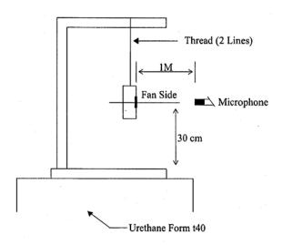
1 METER FROM MICROPHONE TO FAN INTAKE
