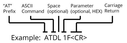
To read a parameter value stored in the RF module's register, omit the parameter field.
