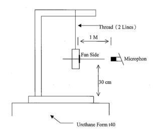
1 METER FROM MICROPHONE TO FAN INTAKE
