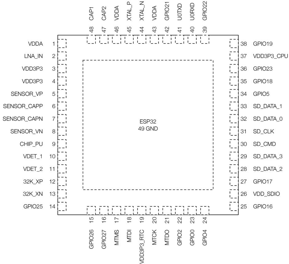
Figure 3: ESP32 Pin Layout (QFN 5\*5, Top View)
