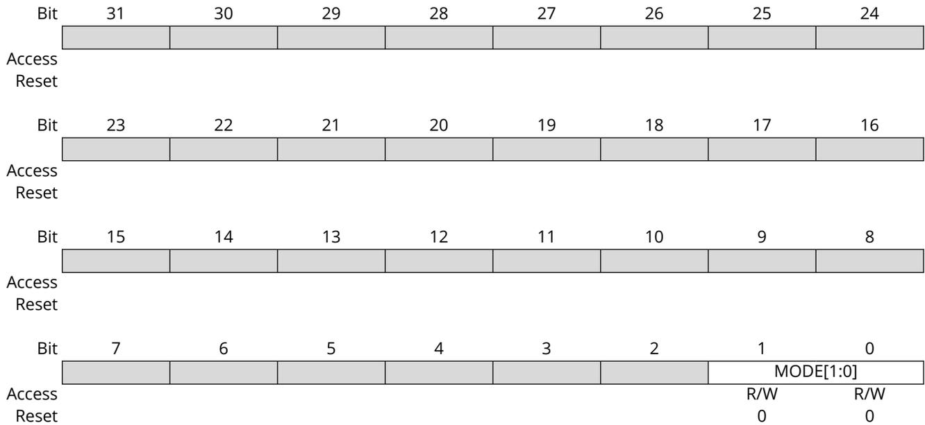
**Bits 1:0 – MODE[1:0]** Cache Controller Monitor Counter Mode
