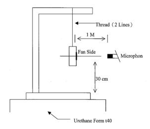
1 METER FROM MICROPHONE TO FAN INTAKE
