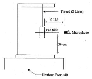
0.1 METER FROM MICROPHONE TO FAN INTAKE
