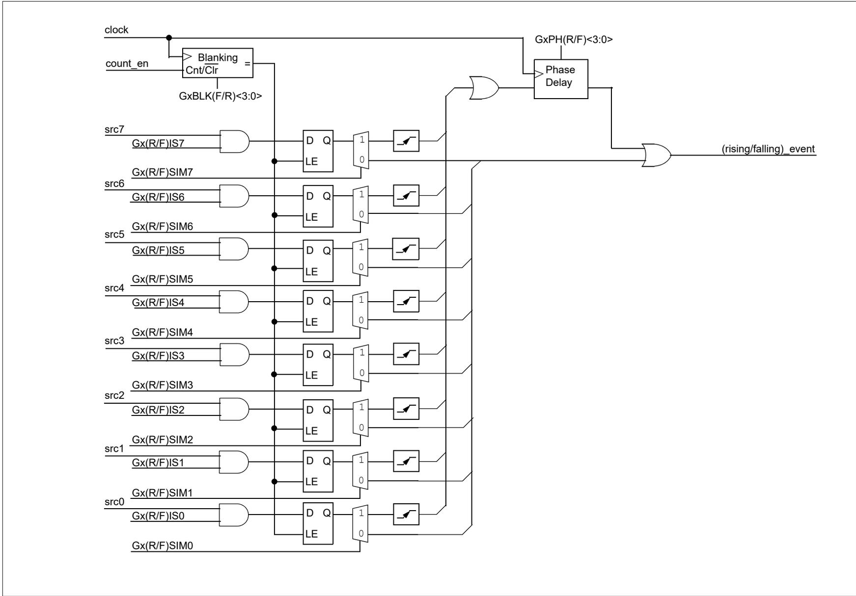
**FIGURE 18-8: COG (RISING/FALLING) DEAD-BAND BLOCK**
