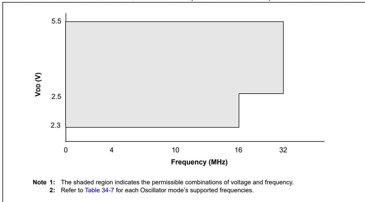
**FIGURE 34-2: VOLTAGE FREQUENCY GRAPH,  $-40^{\circ}\text{C} \leq T_A \leq +125^{\circ}\text{C}$ , PIC16LF1717/8/9 ONLY**
