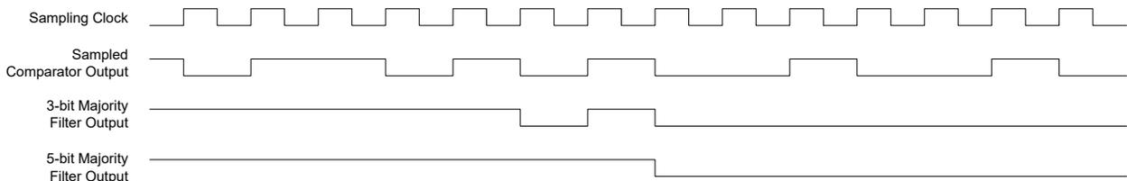
**Figure 34-8. Single-Shot Filtering**
