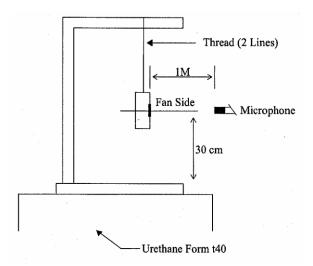
1 METER FROM MICROPHONE TO FAN INTAKE
