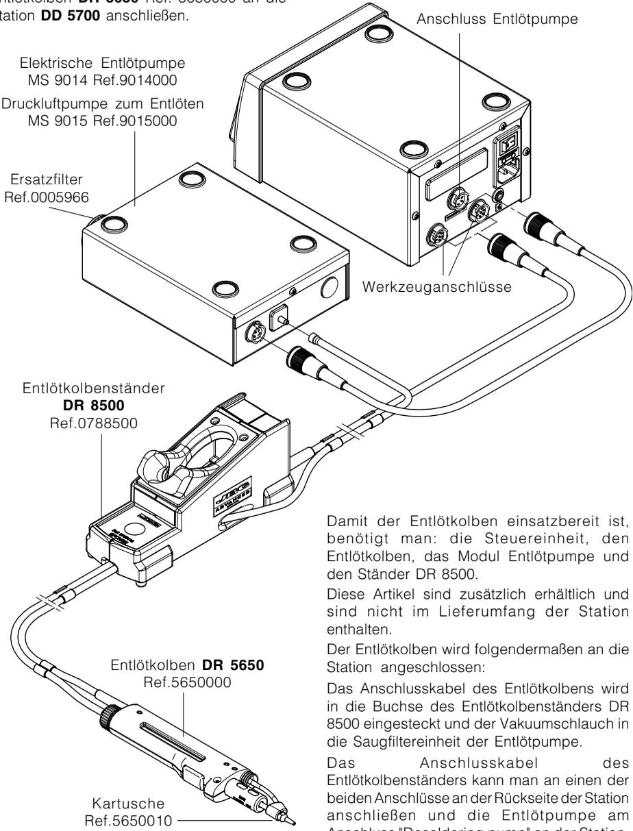
Damit der Entlötkolben einsatzbereit ist, benötigt man: die Steuereinheit, den Entlötkolben, das Modul Entlötpumpe und den Ständer DR 8500.
