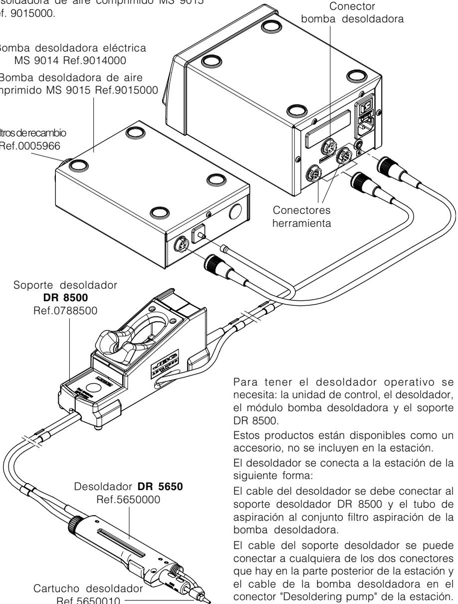
Para tener el desoldador operativo se necesita: la unidad de control, el desoldador, el módulo bomba desoldadora y el soporte DR 8500.
