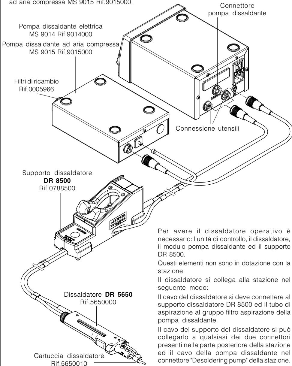
Per avere il dissaldatore operativo è necessario: l'unità di controllo, il dissaldatore, il modulo pompa dissaldante ed il supporto DR 8500.
