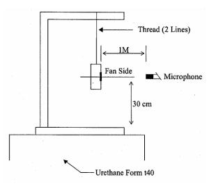
1 METER FROM MICROPHONE TO FAN INTAKE
