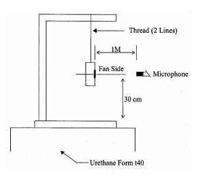
1 METER FROM MICROPHONE TO FAN INTAKE
