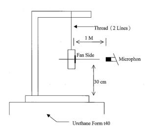
1 METER FROM MICROPHONE TO FAN INTAKE
