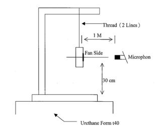
1 METER FROM MICROPHONE TO FAN INTAKE
