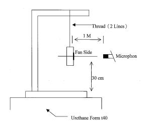
1 METER FROM MICROPHONE TO FAN INTAKE
