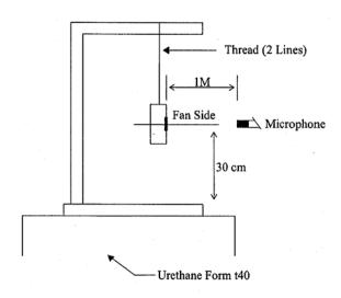
1 METER FROM MICROPHONE TO FAN INTAKE
