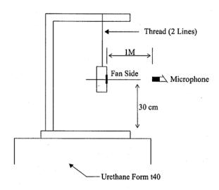
1 METER FROM MICROPHONE TO FAN INTAKE
