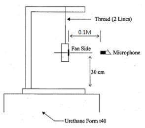
0.1 METER FROM MICROPHONE TO FAN INTAKE
