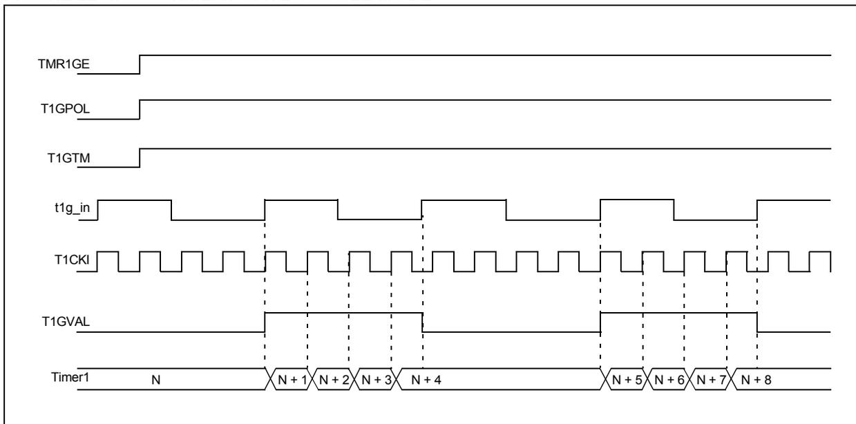
**FIGURE 22-5: TIMER1 GATE SINGLE-PULSE MODE**
