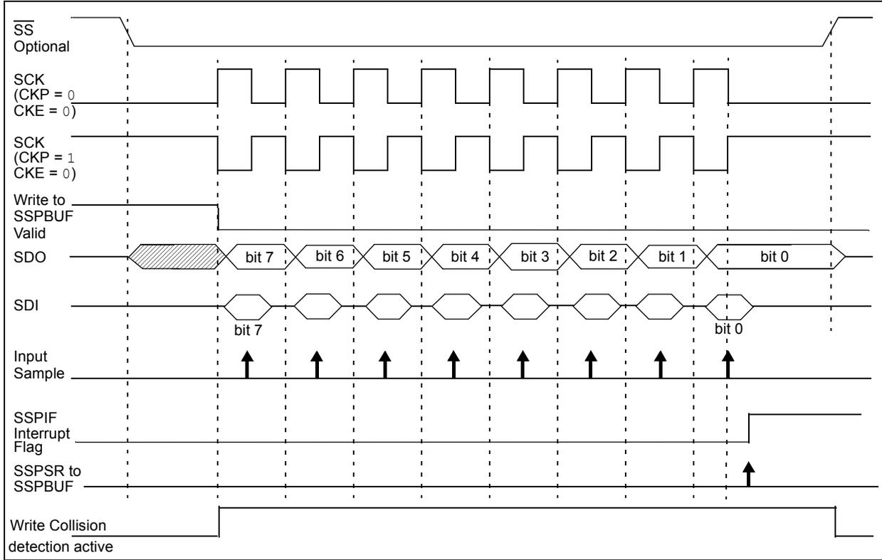
**FIGURE 26-10: SPI MODE WAVEFORM (SLAVE MODE WITH CKE = 1)**
