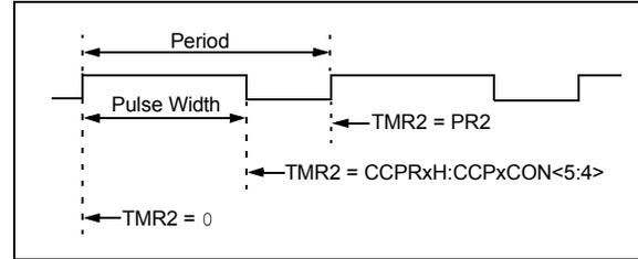
FIGURE 25-4: SIMPLIFIED PWM BLOCK DIAGRAM
