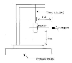
1 METER FROM MICROPHONE TO FAN INTAKE
