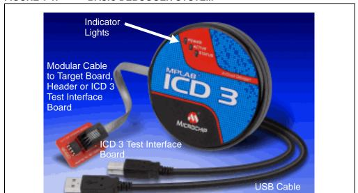
FIGURE 1-1: BASIC DEBUGGER SYSTEM
