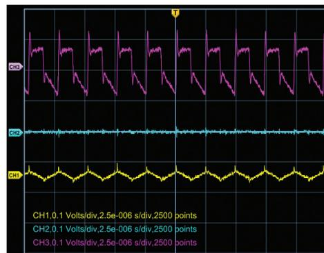
CH1 – Изход, CH2 – пулсации на вх. с LF1, CH3 – пулсации на вх. без LF1
