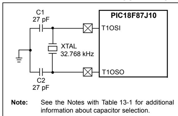
**TABLE 13-1: CAPACITOR SELECTION FOR THE TIMER OSCILLATOR<sup>(2,3,4)</sup>**
