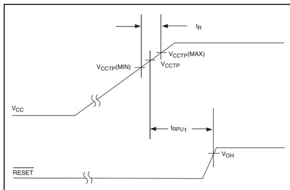
**FIGURE 3-1:** Timing Diagram – Power Up (TC1275/TC1276).
