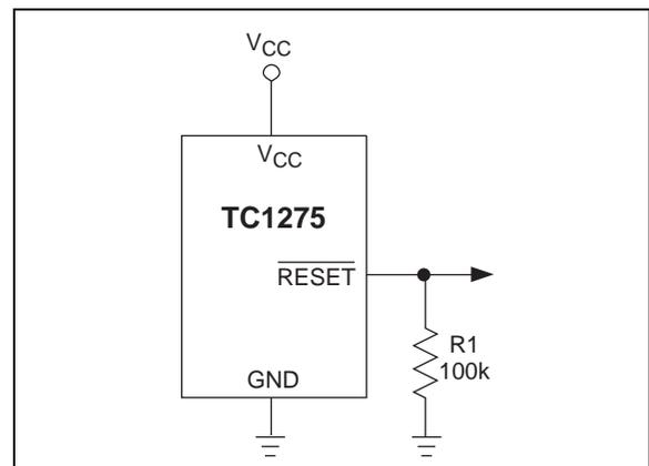
**FIGURE 3-6:** ENSURING  $\overline{\text{RESET}}$  VALID TO V<sub>CC</sub> = 0V.
