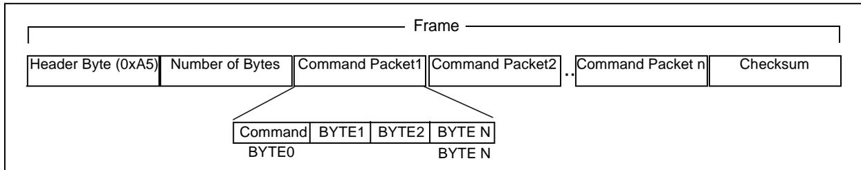
**FIGURE 4-1:** MCP39F501 Communication Frame.
