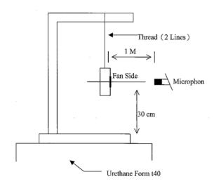
1 METER FROM MICROPHONE TO FAN INTAKE
