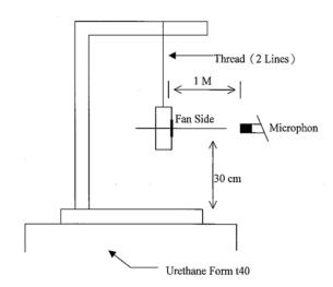
1 METER FROM MICROPHONE TO FAN INTAKE
