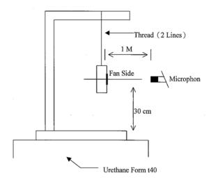
1 METER FROM MICROPHONE TO FAN INTAKE
