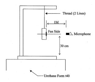
1 METER FROM MICROPHONE TO FAN INTAKE
