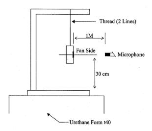
1 METER FROM MICROPHONE TO FAN INTAKE
