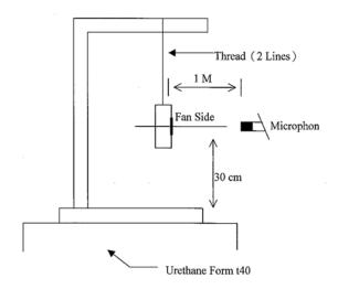
1 METER FROM MICROPHONE TO FAN INTAKE
