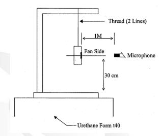
1 METER FROM MICROPHONE TO FAN INTAKE
